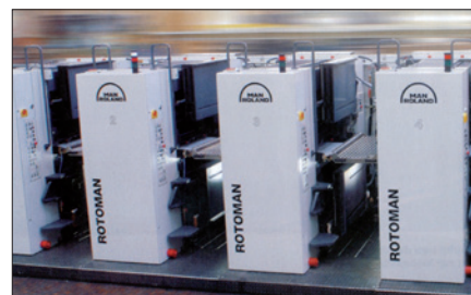
Obr. 2. Nové offsetové tiskařské stroje firmy MAN Roland vybavené elektropohonem a měniči frekvence Sinamics S 120
