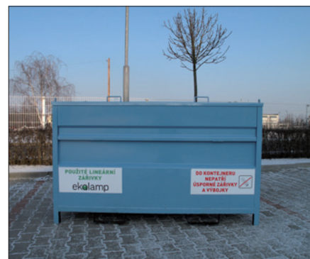
Obr. 3. Modernizovaný typ kontejneru CZ1 určeného pro lineární trubice má lepší ochranu proti nepříznivým povětrnostním podmínkám
