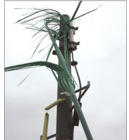
Obr. 4. Detail zničeného anténního systému po přímém úderu blesku [1]
