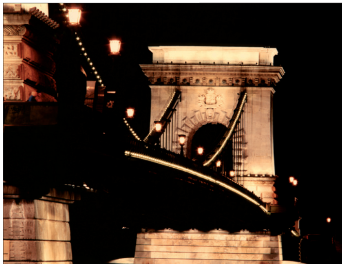
Obr. 4. Osvětlení mostu v Budapešti svítidly se sodíkovými a halogenidovými výbojkami GE
