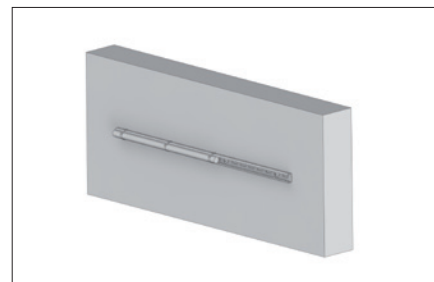
Obr. 5. Ukotvení pomocí nosných lišt
