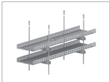
Obr. 3. Upevnění pomocí závitových tyčí
