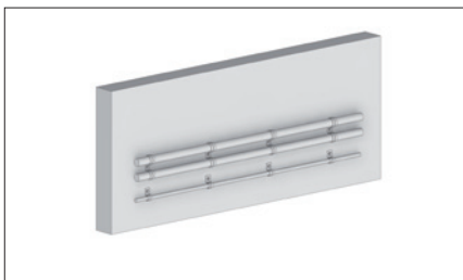
Obr. 7. Upevnění kabelů pomocí jednostranných nebo dvojitých přichytek
