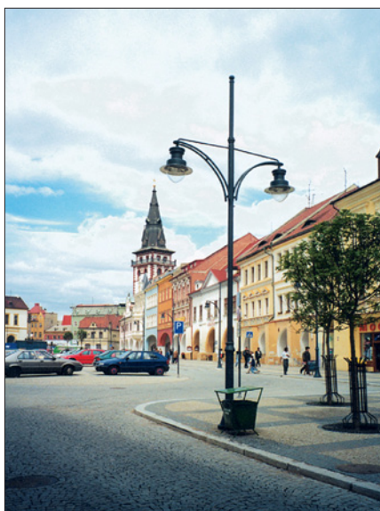
Obr. 3. Historické centrum Chomutova – osvětlovací soustava Hellux NAS 040
