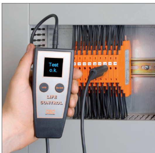
Obr. 4. Přístroj Life Control pro kontrolu svodičů MDP za provozu
