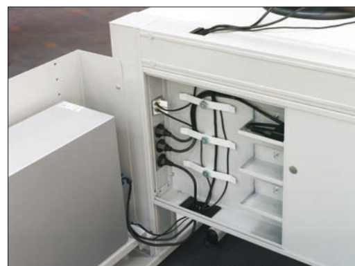
Obr. 7. Strukturované uložení kabelů, zdrojů apod. v systému IAS
