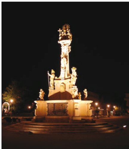
Obr. 4. Svätá trojica Socha svätej trojice je osvetlená svietidlami DecoScene s halogenidovými výbojkami CDM-T/830, ktoré zabezpečujú osvetlenie bez nežiadúceho oslnenia chodcov a obyvateľov priľahlých objektov; na soche sú zvýraznené niektoré významné prvky a zároveň je zabezpečená aj celková rovnomernosť osvetlenia
