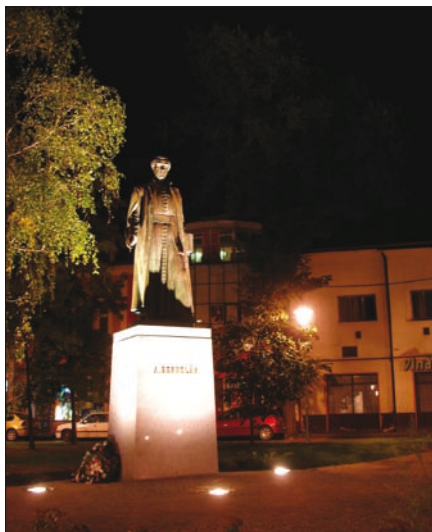
Obr. 5. Anton Bernolák Podobne ako pri osvetlení sochy Szécsényho, aj socha Antona Bernoláka je efektne osvetlená modulárnymi svietidlami DecoScene s halogenidovými výbojkami CDM-T/830
