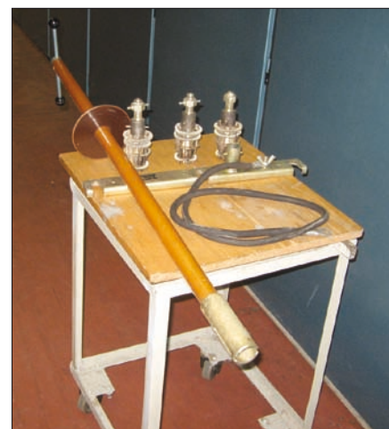
Obr. 4. Speciální zkratovací souprava pro rozváděč IRODEL 25 kV
