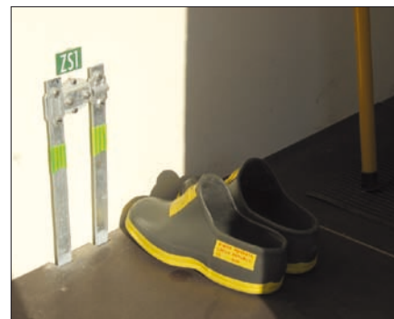
Obr. 5. Izolační obuv do 1 000 V
