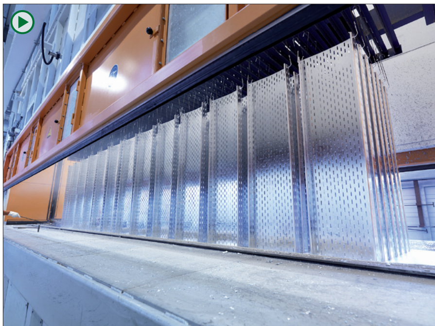
Obr. 1. Žárové zinkování ponorem – zinkovna OBO s vanou 7,5 × 3,5 × 1,4 m (d × v × š) a 260 t zinku
