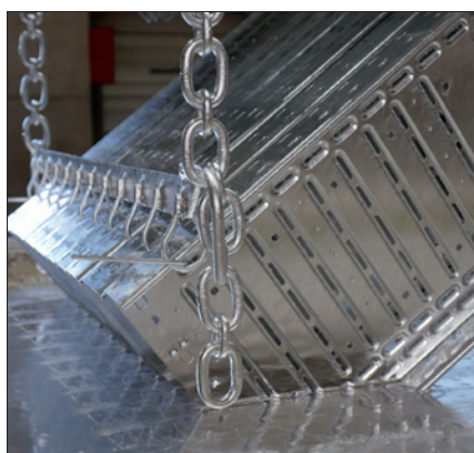
Obr. 6. Zinkování kabelových žlabů RKS M 640 FT ponorem, zinkovna OBO Menden
