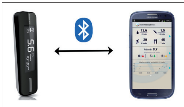
Obr. 4. Transfer dat mezi glukometrem a telefonem
