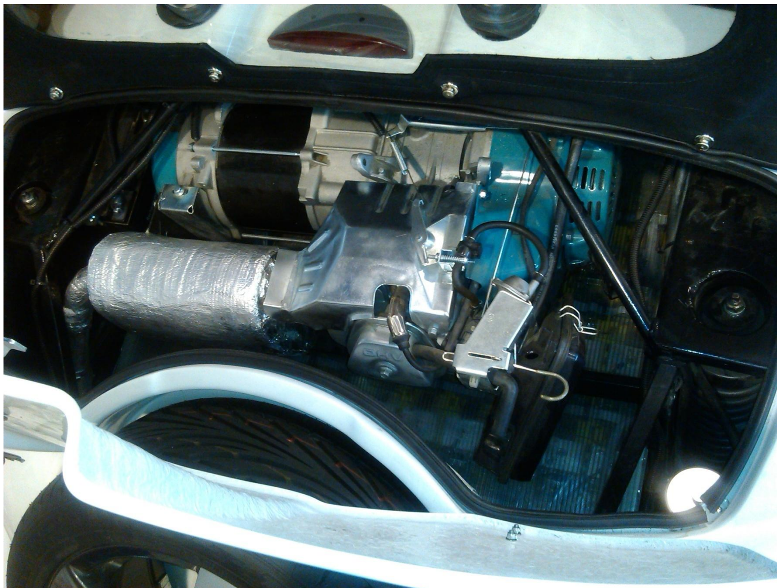
Obr. 43 Finální zástavba RE I.generace do zádi K2 (2011)
