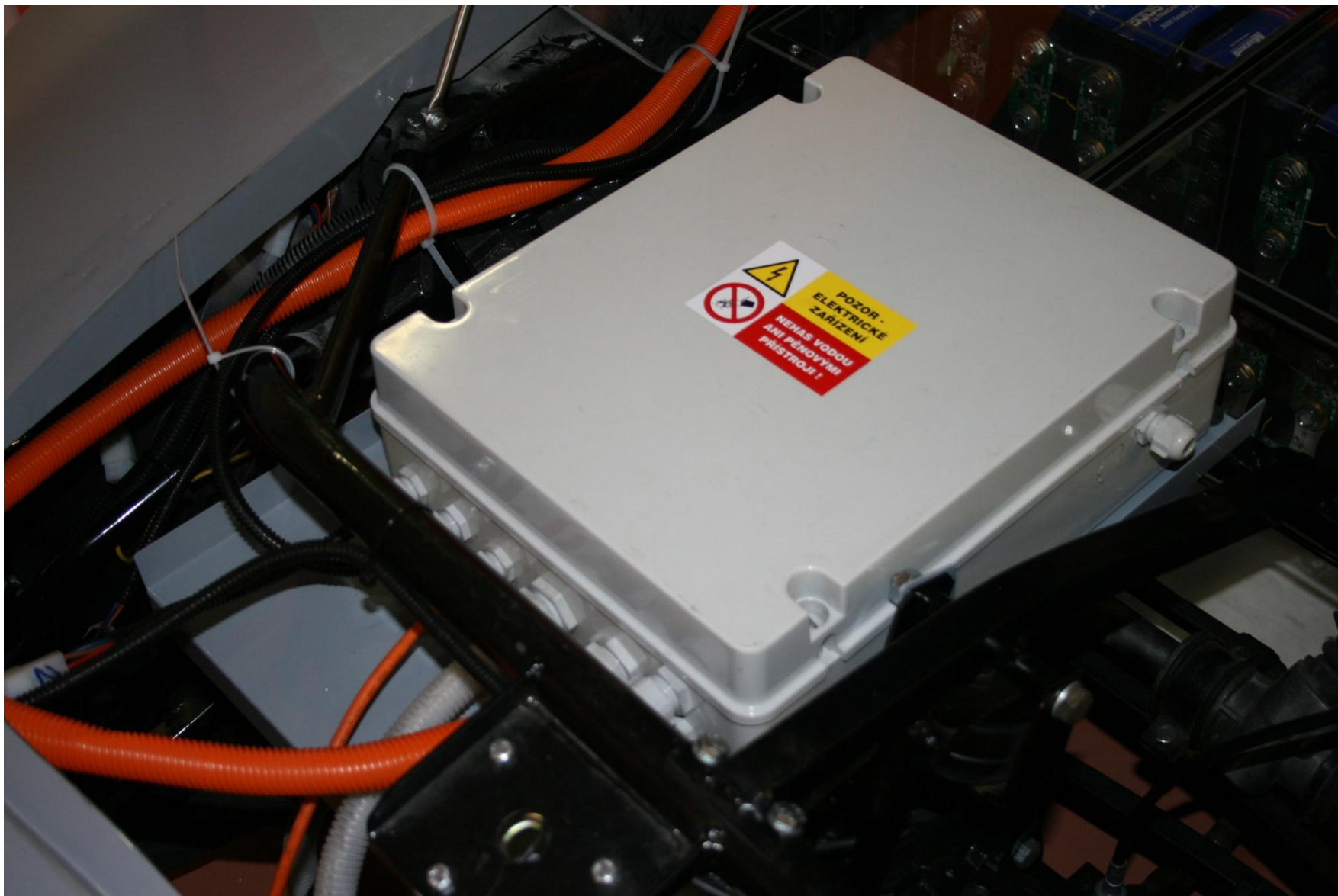
Zástavba řídicí jednotky jednomotorového uspořádání se synchronním motorem v přední části K3 (TG Drives, parametrická realizace, 2012)
