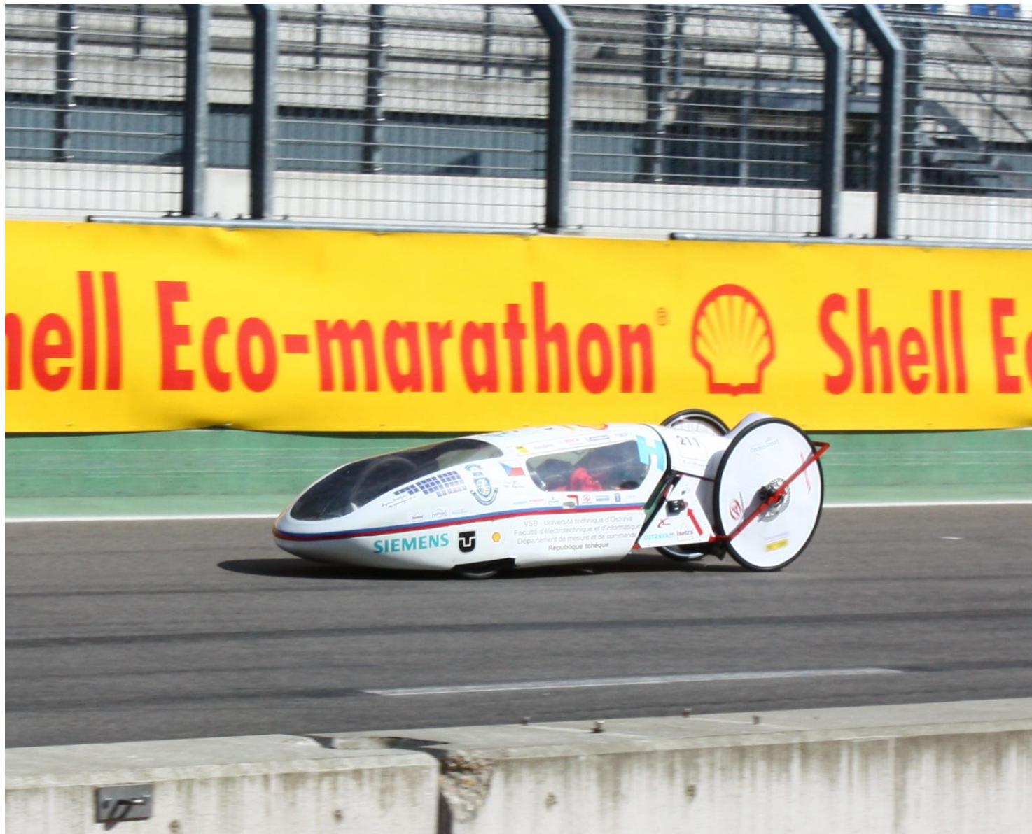
Obr.2c Elektromobil s vodíkovým palivovým článkem, projekt HydrogenIX (2009).
