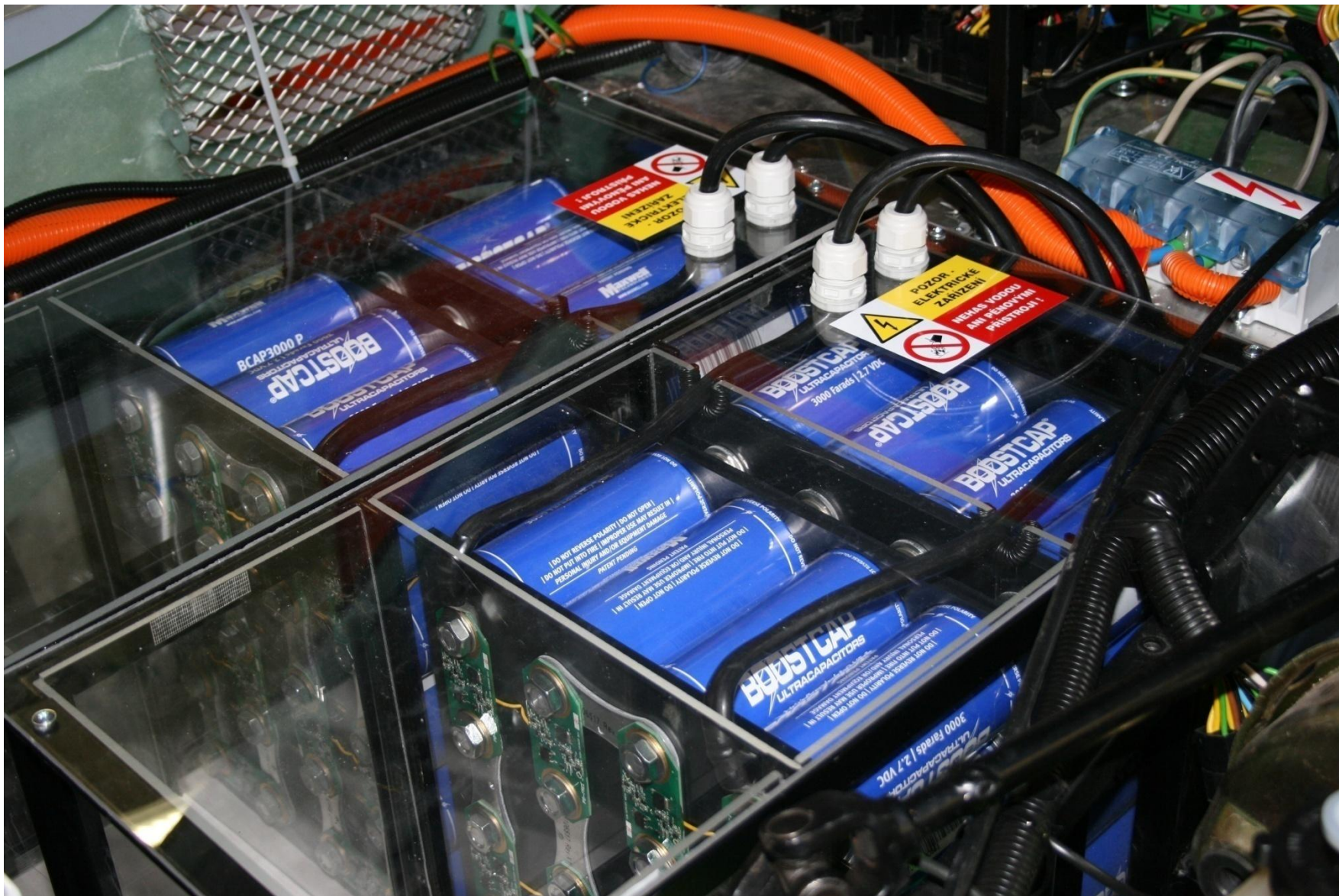
Experimentální soustava superkapacitorů pro palubní zdroj 106V vestavěná do přední zdrojové části K3 (2012/2013)
