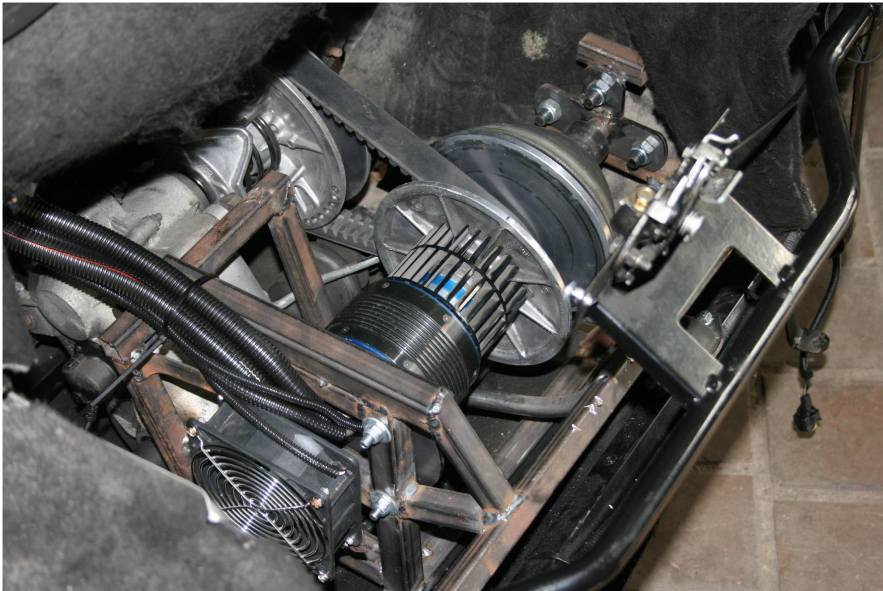
Realizace BLDC pohonu pro demonstrační účely do chassis AIXAM, řídicí elektronika MGM Compro, 2011)
