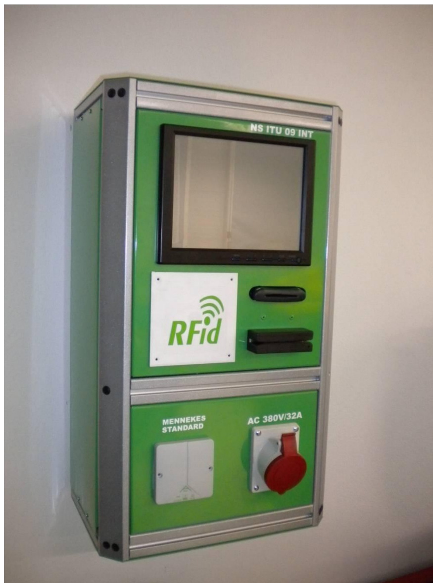
Nástěnná nabíjecí stanice s tarifací odebrané elektrické energie v prototypové laboratoři CPIT C112 (2009).
