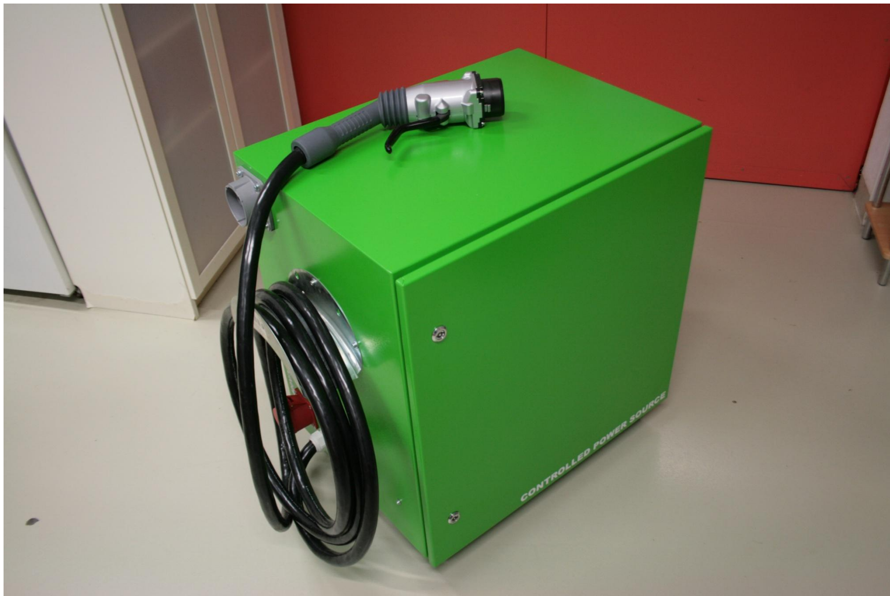
Obr.8b Nabíjecí/vybíjecí stanice elektromobilu, akumulární soustava elektrické energie rodinného domu (2014).
