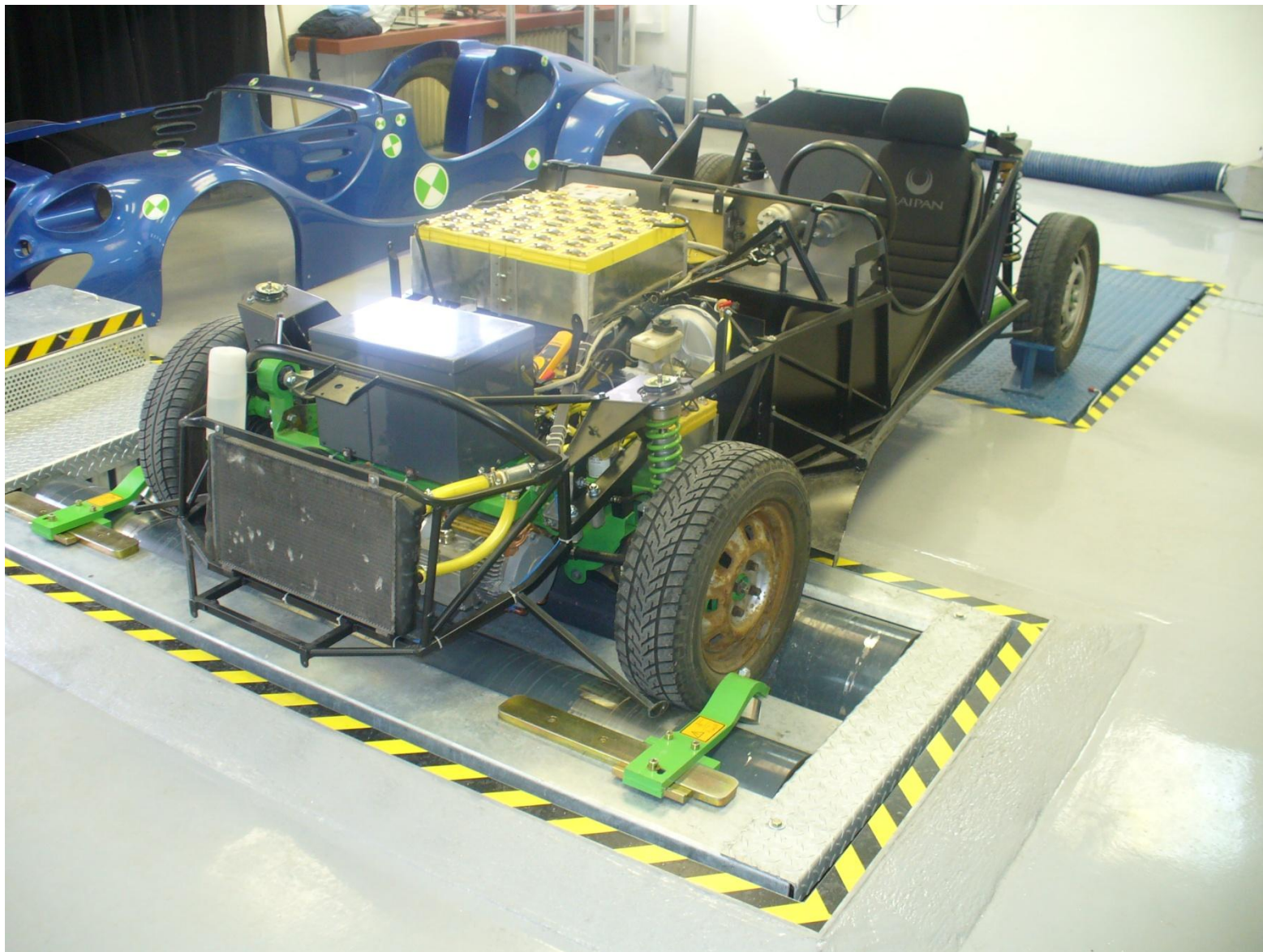
Zástavba frekvenčního měniče I.generace do chassis K0, experimentální test výkonu a maximálního momentu pohonů K0 (2009/2010)
