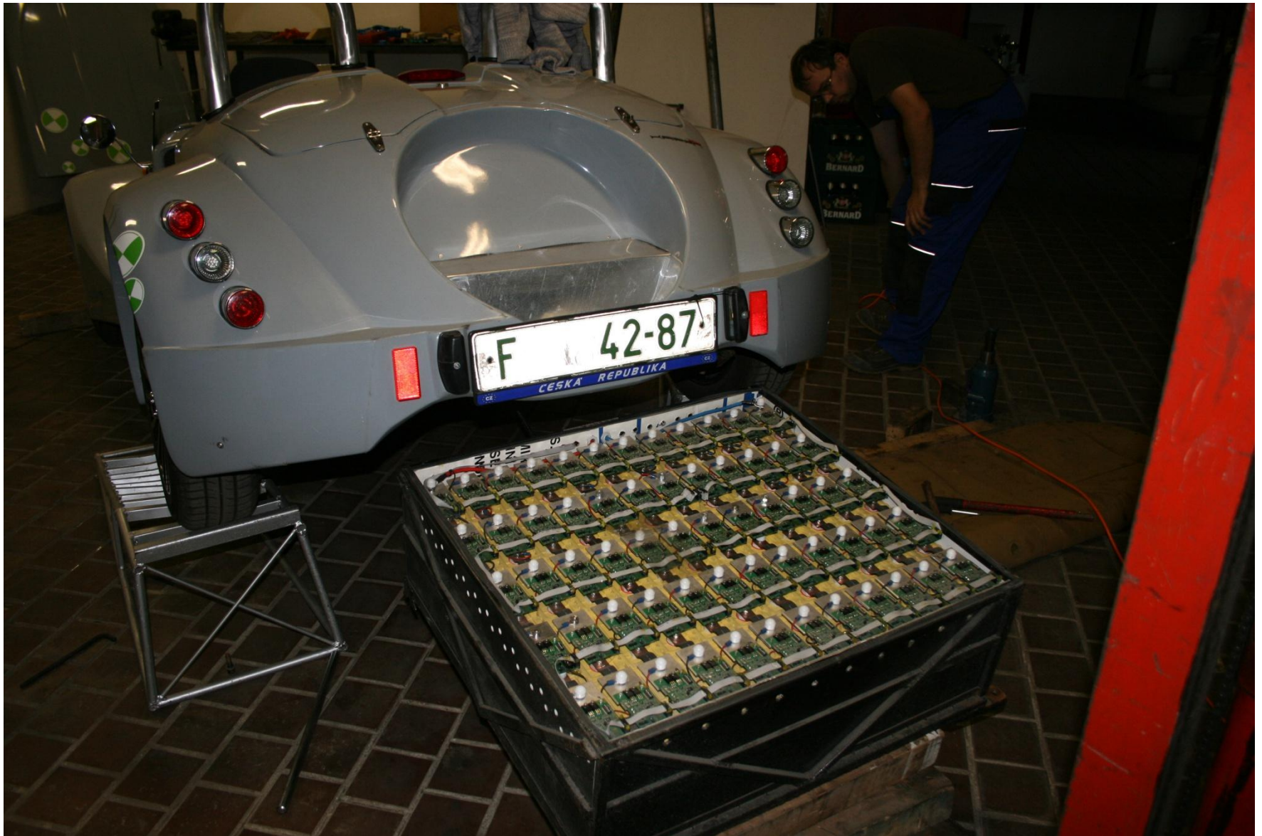
K1 před vestavbou opraveného zadního akumulátorového packu (2011)
