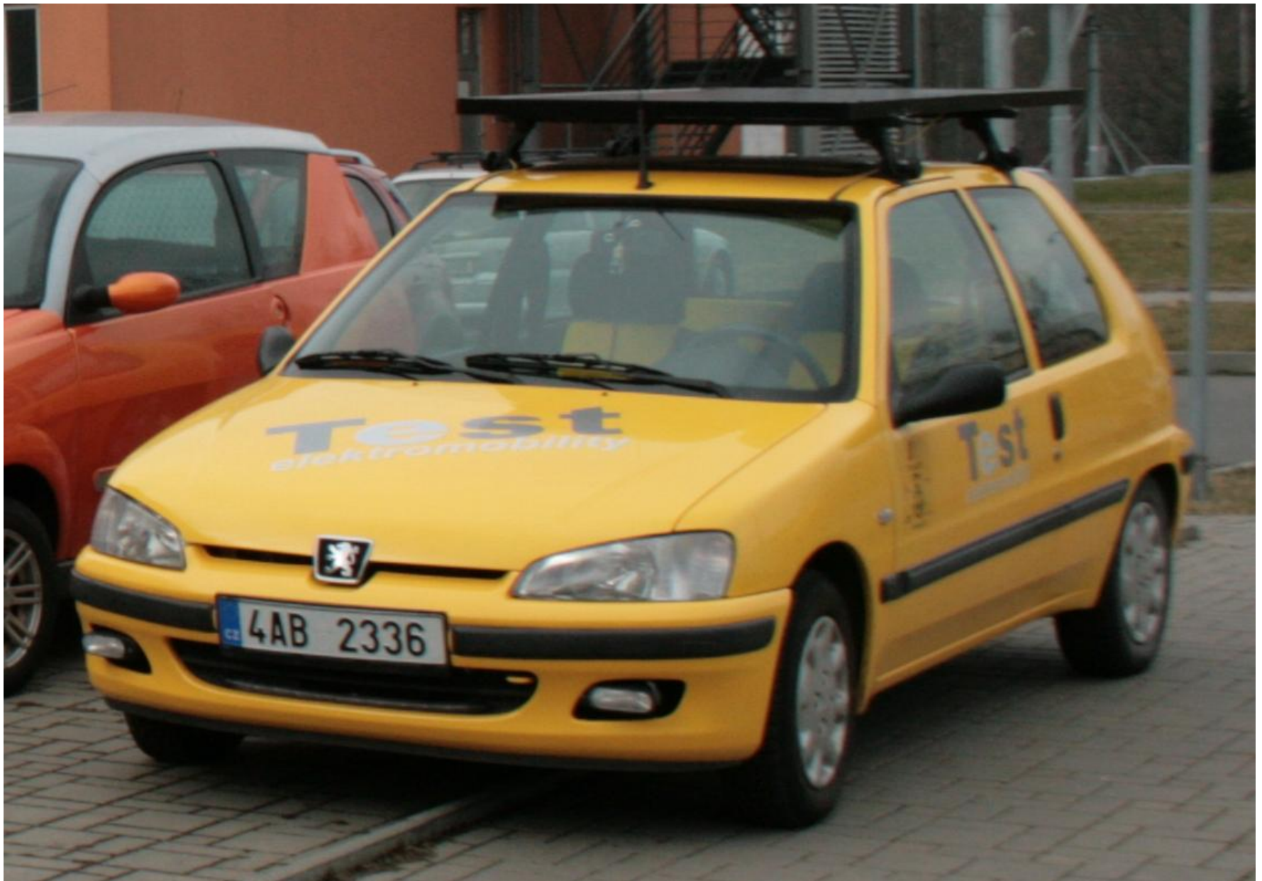
Test Peugeot 106 electric, integrovaný FV panel umožní za slunečného dne nabití až na 10km dojezdu (2014-15).
