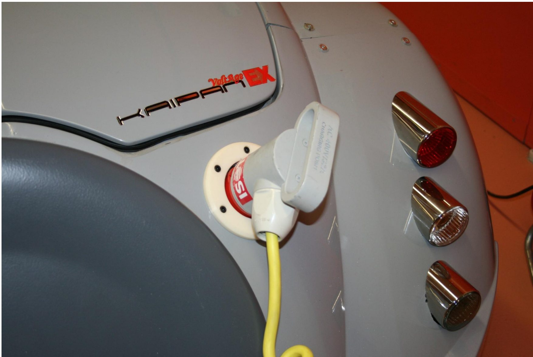
Energetický slot prototypu K3 (MFS – záměnný slot pro Mennekes, CNG a H2 nabíjecí/plnicí koncovku, 2012).
