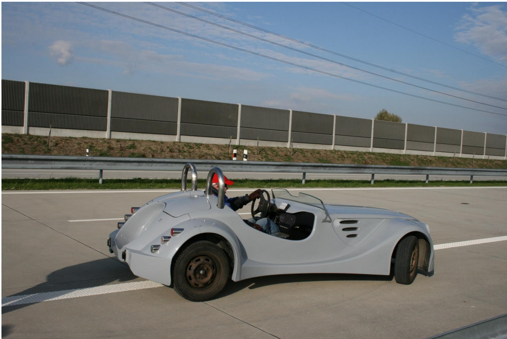
Experimentální elektromobil KAIPAN VoltAge K3 2012 (sériová hybridizace pomocí jednotky prodloužení dojezdu s vodíkovým palivovým článkem a superkapacitory).
